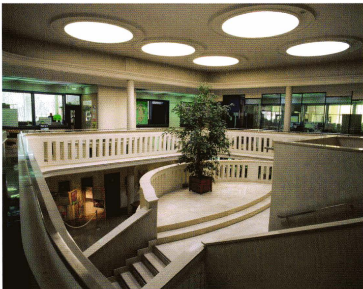
Les lanterneaux du hall de la partie administrative permettent d'éclairer le bâtiment en profondeur.
