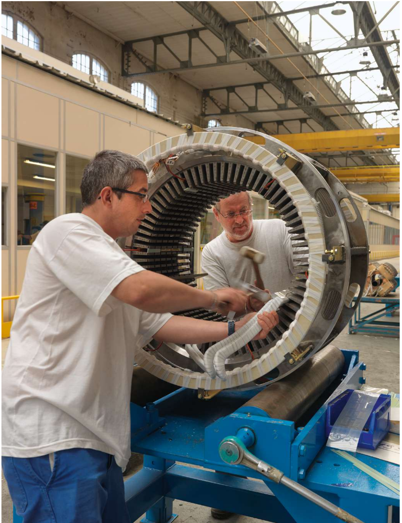
Ci-dessus : atelier de bobinage. La bobine est placée dans les encoches d'une lanterne de stator empilée.
