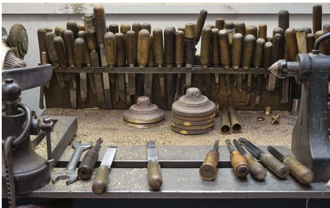
En haut : la tournure permet de mettre en forme et de moulurer les pièces métalliques du lustre.
