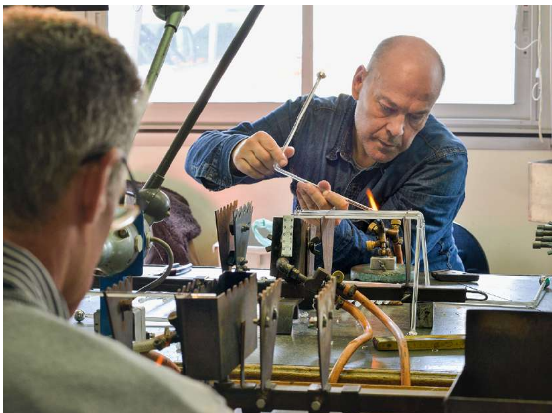
En haut : atelier principal et conditionnement. Au fond, collection d'écrans de sérigraphie utilisés pour réaliser les décors et les échelles des thermomètres. Ci-contre : poste de soudure, fermeture d'un thermomètre coudé.
