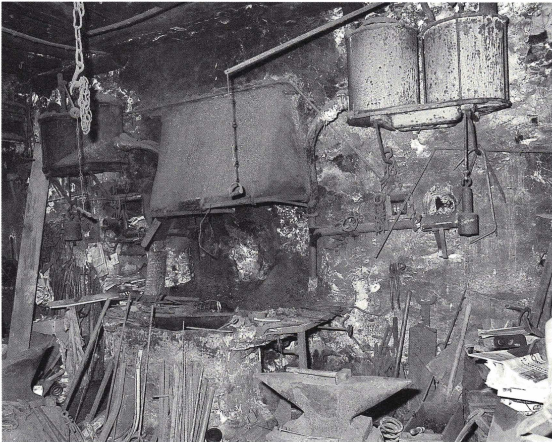
Dans la forge du 34, rue André-Thome, le maréchal-ferrant se consacrait essentiellement à l'entretien du matériel agricole, depuis la quasi disparition des animaux de trait. On reconnaît, au fond, la hotte du foyer; le soufflet est actionné par un système de pistons (en haut à droite). Au premier plan, l'enclume et les outils. L'atelier est aujourd'hui désaffecté. (Photographie de 1983). J.F.
