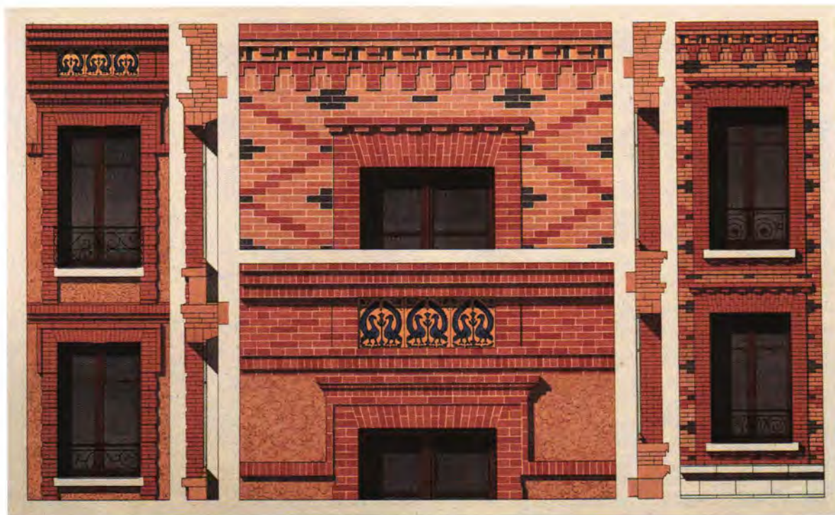
Linteau de briques appareillées en plate-bande : planche 22 de La Brique et la terre cuite... de P. Chabat, 1881.
