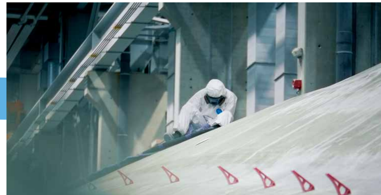
Légende : Fabrication de pales d'éoliennes, LM Windpower, Cherbourg.
